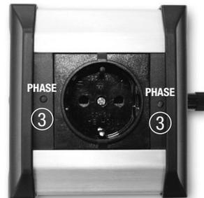
Si tras girar el enchufe 180° se ilumina siempre el mismo LED (3) establezca una conexión con el cable de masa proporcionado entre el PHASER (4) y la masa del aparato a probar. Un punto de masa óptimo es, por ejemplo, el contacto exterior de un conector cinch.
