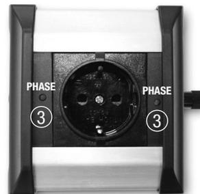
Zou ook na het 180 graden draaien van de stekker dezelfde LED ③ branden, legt u dan een massakabel aan tussen de Phaser ④ en de massa van het te testen apparaat. Een geschikt massapunt is bijvoorbeeld het buitenste contact van een cinchstekker. Daarna herhaalt u de testprocedure en stelt u de juiste fase vast. Uw installatie kan dan op de juiste wijze op de contactdoos aangesloten worden.
