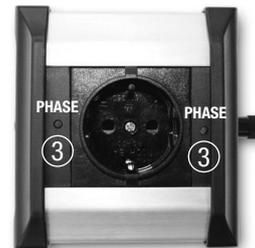
Если же при повороте вилки на 180° горит тот же красный светодиодный индикатор (3), установите соединение между детектором PHASER (4) и массой тестируемого устройства с помощью входящего в комплект измерительного кабеля. Оптимальной точкой измерения является, например, внешний контакт разъема «тюльпан».
