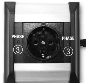
Si après avoir tourné le connecteur à 180° ce sont toujours les mêmes DEL ③ qui s'allument, établissez une liaison avec le câble de masse joint entre le testeur de phase ④ et la masse de l'appareil à tester. Le contact extérieur d'une douille cinch constitue par ex. un point de masse optimal.
