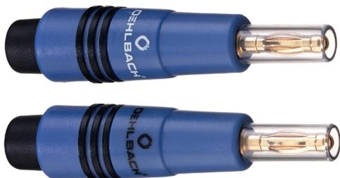
Полностью изолированные бананы подходят для акустических кабелей площадью до 6 мм<sup>2</sup>. Когда банан подсоединяется, изоляционная пластиковая втулка автоматически исчезает в корпусе, а также автоматически втягивается при снятии штепсельной вилки. Это надежно обеспечивает оптимальную защиту от короткого замыкания. Бананы оснащены 24-каратными позолоченными соединениями, которые обеспечивают длительную защиту от окисления.
