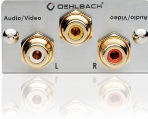
Component-Multimedia-Einsatz aufgebaut mit hochwertigem Lötanschluss. Für den Anschluss eines Component-Kabels auf der Frontseite. Auf der Rückseite befindet sich dann der Lötanschluss. Der Einsatz ist mit 24 Karat vergoldeten Kontakten. In Kombination mit dem Montagerahmen können zwei beliebige Multimedia-Einsätze (alternativ ein Einsatz kombiniert mit einer Blindblende) pro Rahmen mit Innenmaß 50 x 50 mm montiert werden.
