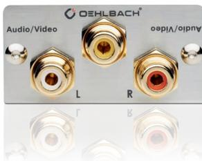
Composant Encart multimédia construit avec une connexion de soudure de haute qualité. Pour le raccordement d'un câble composant sur la face avant. Le raccord à souder se trouve sur la face arrière. L'insert est doté de contacts plaqués or 24 carats. En combinaison avec le cadre de montage, il est possible de monter deux inserts multimédia (ou un insert combiné avec un cache) par cadre avec des dimensions internes de 50x50mm.
