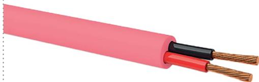
Instalación de cables de altavoces de cobre libre de oxígeno para el cableado de los sistemas de megafonía y todo tipo de sistemas de HiFi. Para lograr las mejores características de sonido, los filamentos individuales de 0,254 mm de grosor y los conductores de la señal están retorcidos juntos. Su llamativa coloración facilita una clara identificación en el conducto de cables. Cable de altavoz estéreo con 2 x 1,5 mm<sup>2</sup> de sección de cable.
