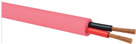
Cavo per altoparlante realizzato con rame privo di ossigeno per il collegamento di tutti i sistemi PA e Hi-Fi. I singoli fili di spessore pari a 0,254 mm e i conduttori di segnale sono intrecciati tra loro per consentire la migliore riproduzione sonora possibile. L'evidente colorazione facilita l'identificazione di questo cavo nelle canaline per cavi. Cavo per altoparlante stereo con sezione trasversale 2 x 2,5 mm<sup>2</sup>.
